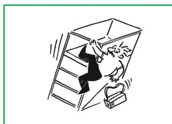
Das Gerüst immer auf der **Innenseite** besteigen. Falls keine Treppen vorhanden sind, klettert man auf der Innenseite an den Seitensprossen via Durchstiegsplattformen hoch. Das Rollgerüst kann beim Hochklettern an der Aussenseite kippen.
