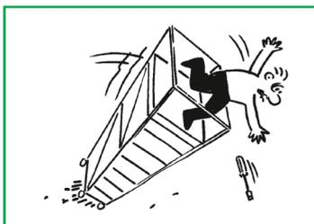
Das **Umherstossen** mit Personen auf dem Gerüst ist strikt untersagt. Das Gerüst darf nur manuell an der Basis verschoben werden.
