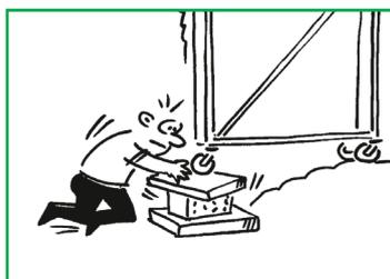
Überprüfen Sie, ob der **Untergrund** auf dem das Gerüst aufgebaut und verschoben werden soll, das Gerüst tragen kann. **Ausleger** müssen gemäss Stückliste montiert werden.
