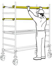
Installer 2 diagonales (gâchette bleue) en sens inverse, entre les 2e et 6e barreaux. Vérifier que les cadres sont d'aplomb et mettre l'échafaudage de niveau au moyen des vérins réglables, en utilisant un niveau à bulle. Installer une paire de cadres supplémentaires et vérifier que les bagues sont enclenchées. Installer les stabilisateurs (voir remarques page 30).
