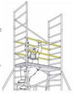
Descendre de l'échafaudage. La plate-forme doit maintenant être repositionnée dans l'échafaudage en la déplaçant à partir des 8e barreaux vers les 6e barreaux (barreaux supérieurs du cadre de base).
