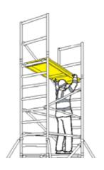
Monter à l'échafaudage par l'intérieur et se placer dans une position de sécurité à l'intérieur de la trappe. Installer les 4 horizontales en tant que garde-corps sur les barreaux supérieurs et inférieurs des cadres de carde-corps des deux côté.
