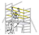
NE JAMAIS se tenir debout sur le plancher avant que les diagonales de garde-corps ne soient en place.
