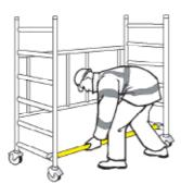
Monter les 4 bagues à ressorts fournies avec le kit de garde-corps. Allonger les bagues au sommet des montants du châssis, puis les faire glisser vers le bas pour enclencher la goupille sur la bague dans l'orifice du montant.
