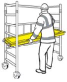
Monter sur la plate-forme en suivant la séquence indiquée. En position assise, monter les horizontales en tant que garde-corps sur les 5e et 7e barreaux, sur le côté ouvert du châssis. Ne pas se tenir debout sur la plate-forme avant que les garde-corps ne soient en place.
