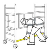
Monter les 4 bagues à ressorts fournies avec le kit d'extension. Allonger les bagues au sommet des montants du châssis, puis les faire glisser vers le bas pour enclencher la goupille sur la bague dans l'orifice du montant.
