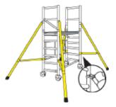
Monter à l'échafaudage par l'intérieur et se placer dans une position de sécurité à l'intérieur de la trappe. Installer les 4 horizontales en tant que garde-corps sur les barreaux supérieurs et inférieurs des cadres de garde-corps, des deux côtés de la plate-forme. IMPORTANT: Toujours vérifier que les diagonales sont complètement
