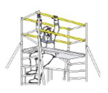
Quand les horizontales sont installées en tant que garde-corps, elles doivent toujours se situer à 0,5 m et 1 m au-dessus du niveau du plancher.
