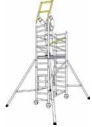
9 Monter une quatrième diagonale entre le barreau inférieur du cadre de garde-corps à 2 barreaux et le cadre d'extension à 8 barreaux.
