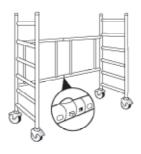
Bloquer les freins des quatre roues. Vérifier que les roues sont orientées vers l'extérieur du châssis.
