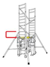
Enclencher les tirettes anti-soulèvement, sous les barreaux, aux extrémités du plancher. Monter sur l'échafaudage et se placer dans la position de sécurité au niveau de la trappe. Remonter les 4 diagonales de garde-corps, les barreaux 2 et 4 au-dessus de la plate-forme, sur les deux côtés de l'échafaudage.
