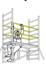
Monter une troisième diagonale. La diagonale doit suivre un chemin en zigzag sur les côtés alternés de l'échafaudage. Installer les 4 bagues à ressorts fournies avec le kit de garde-corps. Monter un cadre de garde-corps à deux barreaux sur chaque extrémité du châssis. Vérifier que les 4 bagues de cadre sont enclenchées.
