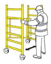
1 Placer le châssis dans la position requise et déplier les cadres d'extrémité.
