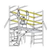
Repositionner une plate-forme à trappe sur les 14e barreaux de l'échafaudage (barreaux supérieurs du cadre d'extension inférieur à 8 barreaux).
