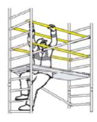
Monter 4 horizontales en tant que garde-corps, 2 et 4 barreaux au-dessus du plancher, sur les deux côtés de l'échafaudage.
