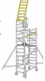
Monter une quatrième diagonale en poursuivant le schéma en zigzag sur les côté alternés de l'échafaudage.
