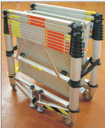
1. Hauptbaugruppe mit zusammengeklappter Arbeitsbühne
