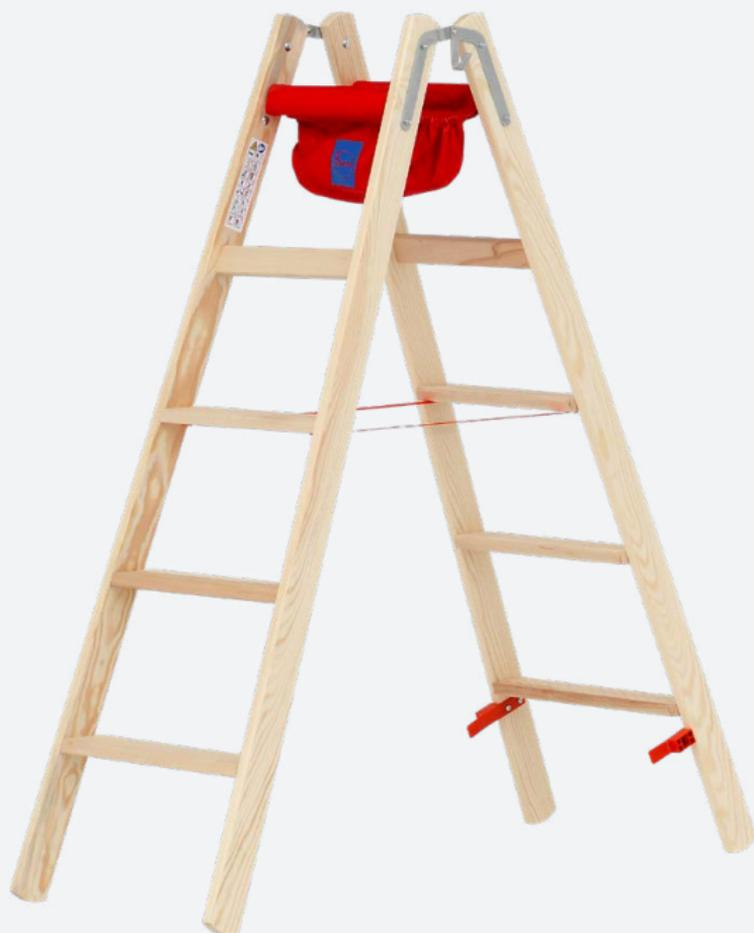
Stehleitern aus Holz sind für viele Profianwender tägliches praktisches Arbeitsmittel – üblicherweise mit einer Sprossenstärke von 20–50 mm. Gemäß der aktuellen TRBS 2121-2\* dürfen Leitern jedoch nur als Arbeitsplatz verwendet werden, wenn der Benutzer mit **beiden Füßen auf einer Stufe (mind. 80 mm)** oder Plattform steht – wie auf der neuen Holz-Stufenstehleiter 71499 von HYMER. Sicheres und ergonomisches Arbeiten ganz im Sinne der Berufsgenossenschaften.
