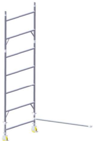
Mettez l'autre assemblage de cadres à la verticale et fixez l'extrémité de la barre horizontale sur le montant de l'autre barreau de base. Fixez une seconde horizontale entre les barreaux de base de l'autre côté des cadres, mais cette fois sur le barreau horizontal. Fixez une barre diagonale (gâchette bleue) entre le premier et le cinquième barreau de la tour, comme indiqué ci-dessous.
