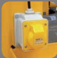
Stromanschluss auf Arbeitsbühne
